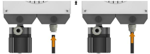
Zum Anschließen der Push-Fit Wasseranschlüsse den Schlauch fest bis zum Anschlag hineindrücken. Dabei darauf achten, dass der Schlauch gerade zum Anschluss zeigt und keine scharfen Kanten oder einen Grat aufweist. Ggf. den Grat mit einer Feuerzengflamme entfernen.
