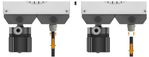
Zum Lösen der Push-Fit Verbindung den grauen Ring in Richtung des Kühlers drücken und anschließend den Schlauch entfernen. Erst am Schlauch ziehen nachdem der graue Ring gedrückt wurde.
